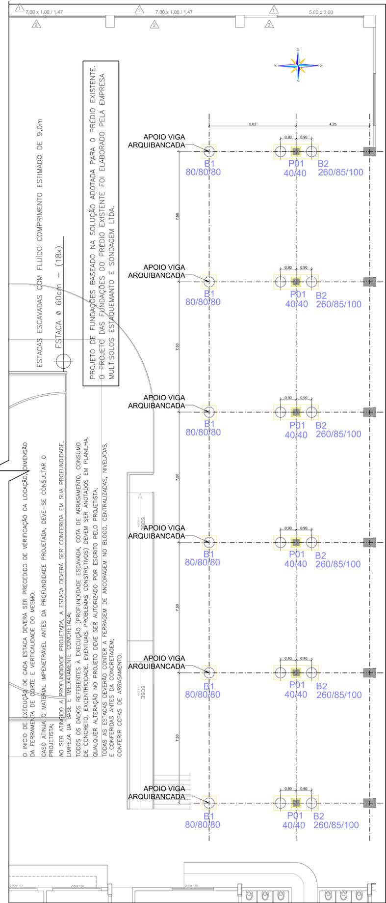
ESTACAS ESCAVADAS COM FLUIDO COMPRIMENTO ESTIMADO DE 9,0m
